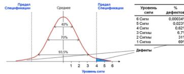
Рисунок 1 – Отражение принципа действия шесть сигм в улучшении процессов
